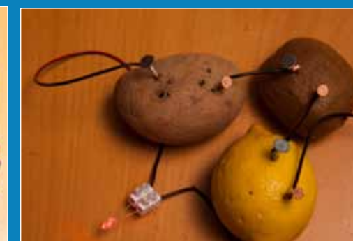
Chceme-li dosáhnout vyššího napětí, musíme seřadit články do série, tedy propojit navzájem zinkové a měděné hřebíky. Brambora s citronem dávají 1,81 V.
