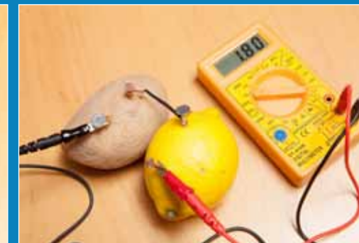
Chceme-li dosáhnout vyššího napětí, musíme seřadit články do série, tedy propojit navzájem zinkové a měděné hřebíky. Brambora s citronem dávají 1,81 V.
